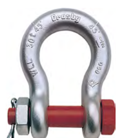
Manilha G-2140 Alloy Cumprir os requisitos US Fed. Spec.RR-C-271F Tipo IVA Classe 3 C.M.U.: de 2t a 400t
