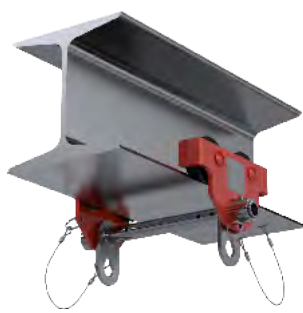
ST 012 EN 795/B CEN/TS 16415 Força estática: 13 kN Viga de 50mm a 380mm Número de utilizadores: 2
