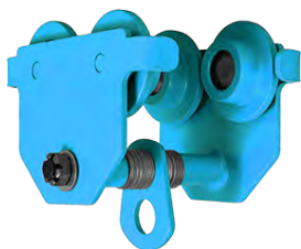
Carro mono viga de empurrão C.M.U.: 500kg a 5 000kg. Para vigas de 50mm a 203mm - CMV1 (várias opções)
