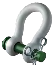
Manilha ROV P-5363 G8 Polar Com cavilha de mola C.M.U.: de 6,5t a 85t - 6:1 C.M.U.: de 120t a 250t - 5:1
