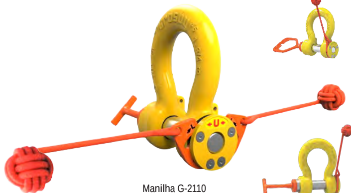
Manilha G-2110 Galvanizada e pintada e pintada de amarelo C.M.U.: de 9,5t a 85t - 6:1
