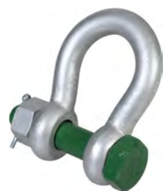
Manilha G-4163 Gr.6 EN 13889 Atende os requisitos US Fed. Spec. RR-C-271 Tipo IVA Classe 3 C.M.U.: de 0,5t a 85t
