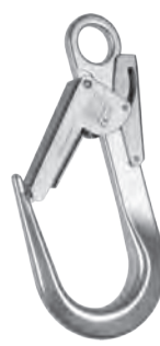
AZ 027 (Aço inox) EN 362/A 256×130mm Abertura: 68mm Força estática: 20 kN
