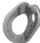
AT 180 (Aço inox) EN 795/A Força estática: 12 kN 56×48×35mm Ø17mm Número de utilizadores: 1
