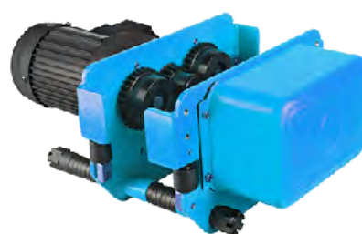
Carro mono viga eléctrico C.M.U.: 500kg a 12 500kg. 1 ou 2 velocidades Para vigas de 50mm a 310mm - CMV3 (várias opções)
