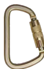
AZ 017T (Aço) EN 362/B 120×77mm Abertura: 25mm Força estática: 20 kN
