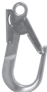
AZ 023 (Aço) EN 362/A 240×108mm Abertura: 56mm Força estática: 20 kN
