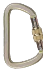
AZ 017 (Aço) EN 362/B 120×77mm Abertura: 25mm Força estática: 20 kN
