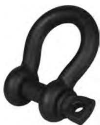
Manilha G-4161T (Cor preta) Para uso em locais de entretenimento Gr.6 EN 13889 Atende os requisitos US Fed. Spec. RR-C-271 Tipo IVA Classe 2 C.M.U.: de 0,33t a 8,5t
