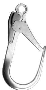
AZ 024 (Al) EN 362/A 365×168mm Abertura: 110mm Força estática: 20 kN
