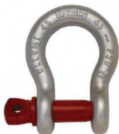
Manilha G-209 Cumprir os requisitos US Fed. Spec.RR-C-271F Tipo IVA Classe 2 C.M.U.: de 0,33t a 55t
