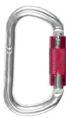
AZ 012T (Al) EN 362/B 110×64mm Abertura: 21mm Força estática: 25 kN
