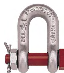
Manilha G-2150 Cumprir os requisitos US Fed. Spec.RR-C-271F Tipo IVA Classe 3 C.M.U.: de 0,33t a 85t
