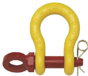
Manilha G-209R Galvanizada e pintada de amarelo fluorescente C.M.U.: de 6,5t a 55t - 5:1
