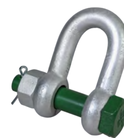
Manilha G-4153 Gr.6 EN 13889 Atende os requisitos US Fed. Spec. RR-C-271 Tipo IVB Classe 3 C.M.U.: de 2t a 85t
