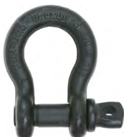
Manilha G-209T (Cor preta) Para uso em locais de entretenimento Cumprir os requisitos US Fed. Spec.RR-C-271F Tipo IVA Classe 2 C.M.U.: de 1t a 4,75t
