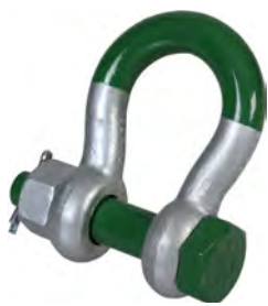
Manilha G-5263 Em aço Gr.8 ASME B30.26 Atende os requisitos da US Fed. Spec. RR-C-271 Tipo IVA Classe 3 C.M.U.: de 3,3t a 175t
