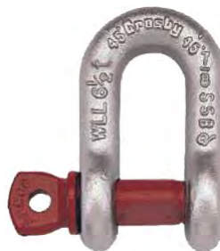
Manilha G-2130 Cumprir os requisitos US Fed. Spec.RR-C-271F Tipo IVA Classe 2 C.M.U.: de 0,33t a 55t
