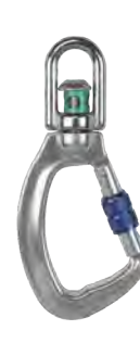
AZ 030I (Al) EN 362/T 117×82mm Abertura: 23mm Força estática: 20 kN Com indicador de queda
