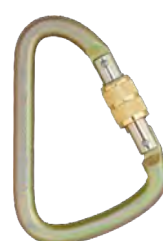
AZ 018 (Aço) EN 362/B 126×87mm Abertura: 27mm Força estática: 20 kN
