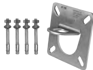
AT 180 (Aço galvanizado) EN 795/A Força estática: 30 kN 150×150mm Ø40mm Número de utilizadores: 3
